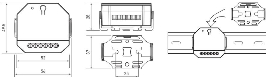
Рис. 1. Габаритный чертеж
