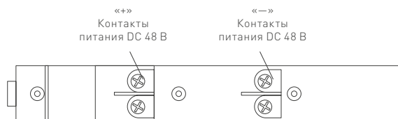
Расположение контактов на шинпроводе и в коннекторе питания MAG-ORIENT-CON-POWER (пластиковая крышка снята)
